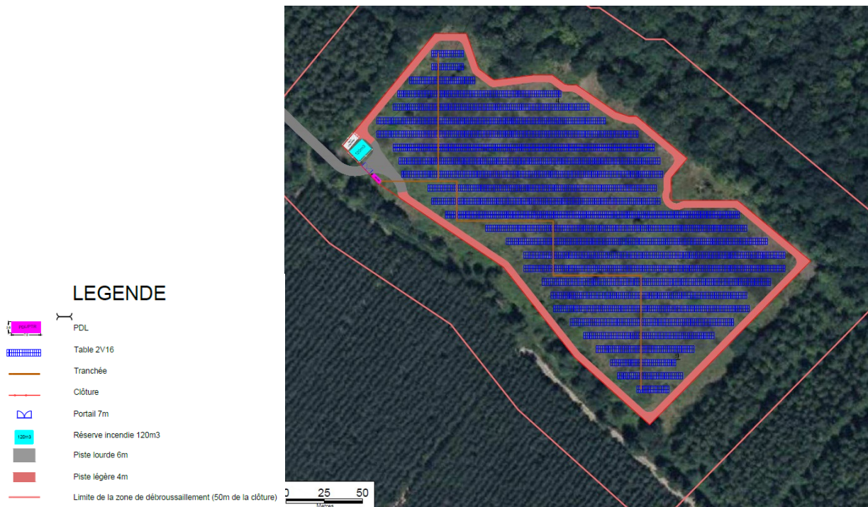
Plan de masse de la variante retenue et périmètre de débroussaillage - extrait étude d'impact page 222
